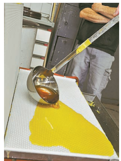
Hier wird heißes Wachs in die Gussform für Mittelwände gegeben.
