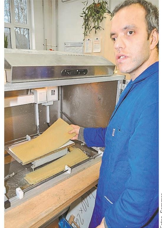
Mesud Demeri bedient die Schneidemaschine, die Mittelwände auf die verschiedenen Rähmchenmaße bringt, zum Beispiel Dadant oder Deutsch-Normal.
